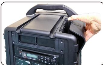
(B) 將佩戴發射器依收藏槽形狀天線朝下至定位。
